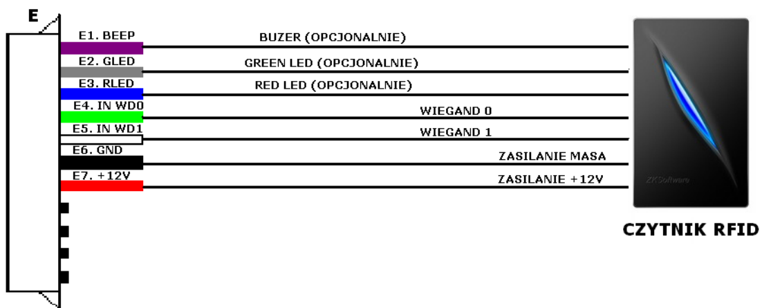
Rys. 15. Złącze E: Podłączenie zewnętrznego czytnika RFID do wejście Wiegand IN.
