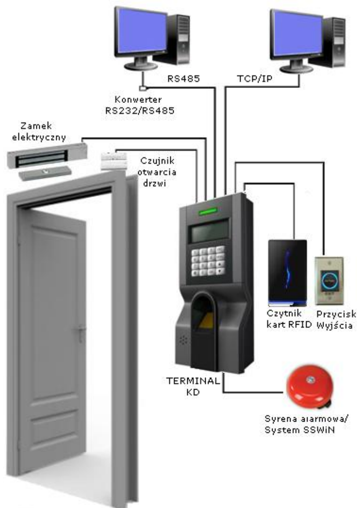
Rys. 1. Konfiguracja autonomicznego systemu Kontroli Dostępu.
